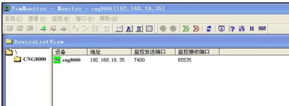
PcmMonitor 是世纪网通公司的通用 E1 监控软件，可以监控世纪网通生产的所有提供 E1 接口的设备。
