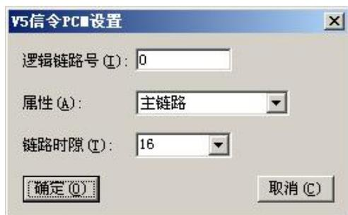
**逻辑链路号**，标识 V5 链路内 PCM 顺序的一个逻辑编号，对接两边必须一致。
